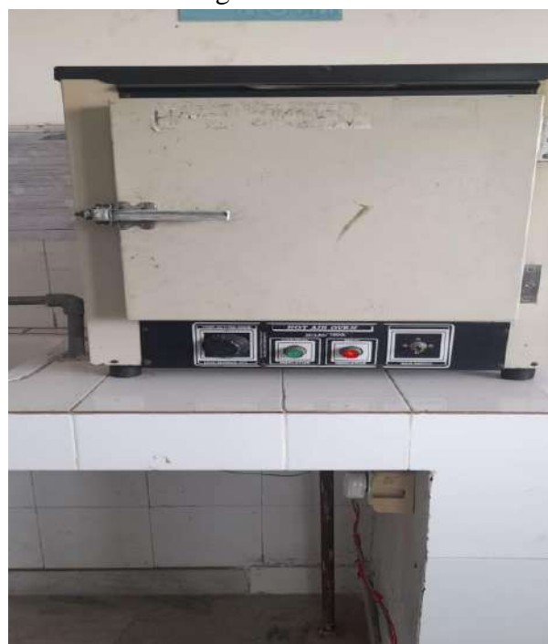
Fig 8 : Hot air oven
